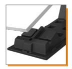
Das Modul wird zwischen zwei HDPE-Sockel 200 gelegt, und zwar in die speziell vorgefertigte, Rahmen bildende Einkerbung.
